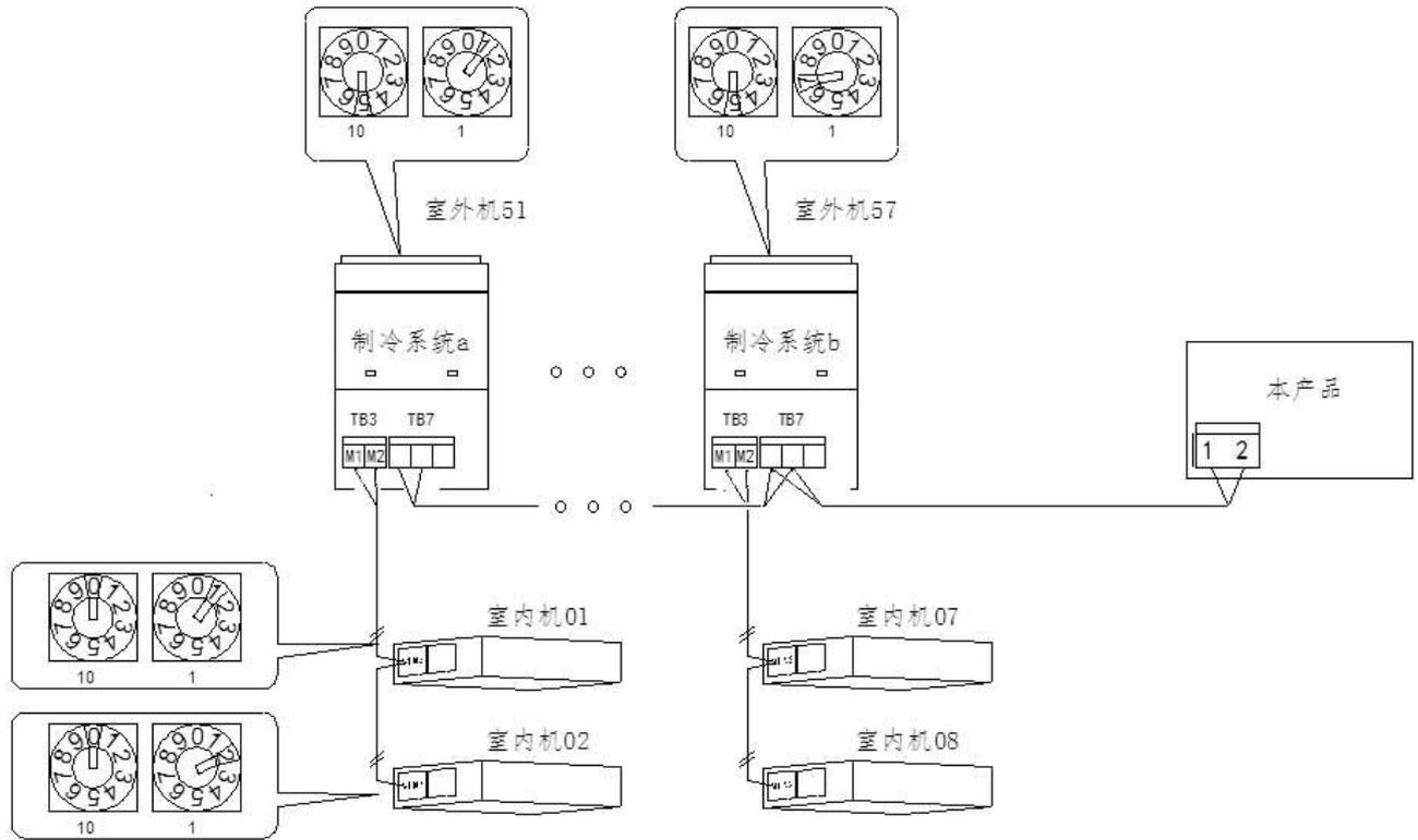
1、如果只有一套制冷系统：空调与该模块相连接的 2 芯线压接在室外机“内外机通讯”的“M1，M2”接线端子上，或者接在室内机上标识“M1，M2”的接线端子上（无极性区分）。注意：请勿接入到室外机“集中控制 TB7”的“M1”和“M2”端子上。
