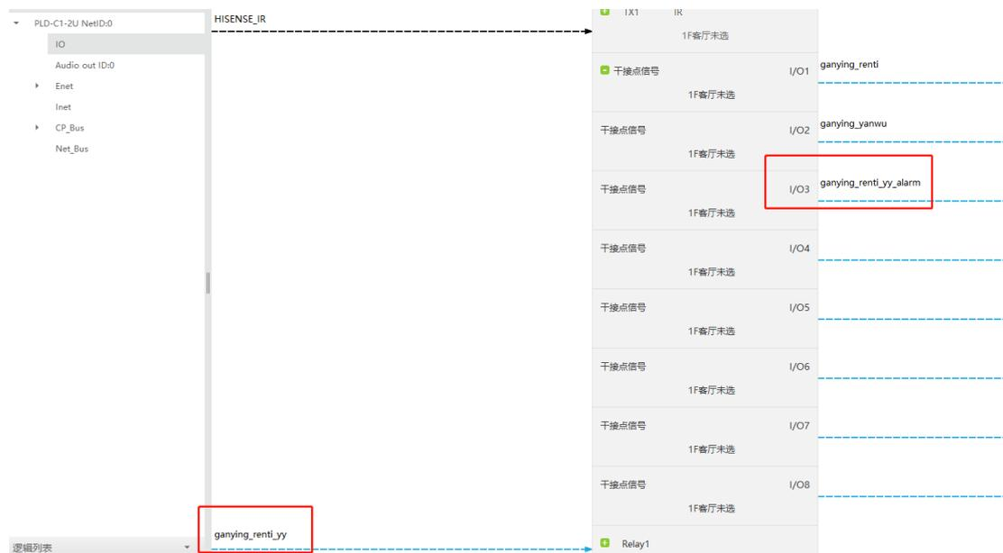
下图中，感应器在布防情况下触发需要触发的场景逻辑和关联到报警 APP 块上，同时让上一步的继电器吸合。这样通过外部线路连接的 IO 口的变量就会被触发。如果该变量被进行过场景映射，那么会触发映射后的场景。
