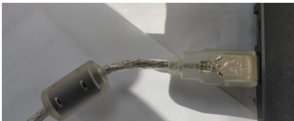
USB 转 232 的 USB 口接电脑 USB 口
