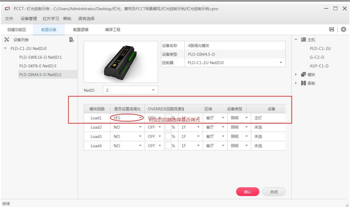
图 2-1.1 为调光模块“PLD-DIM4.5-D”配置是否调光
