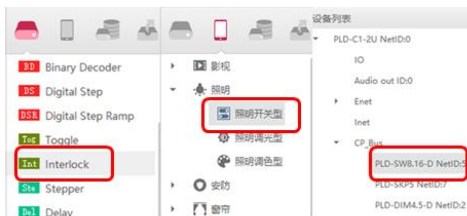
图 1-1 PCCT 配置灯光开关逻辑添加功能块图示
